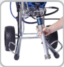
Open Door & Remove Pump
